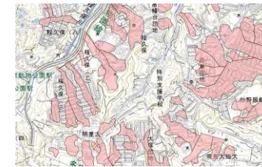
大規模盛土造成地
